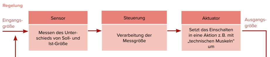
Die Ausgangsgröße wird zum Eingang zurückgeführt und mit der Eingangsgröße verglichen.
